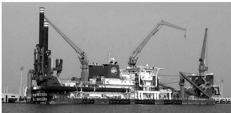
“新海旭”绞吸挖泥船挖掘细粉沙每天可以疏浚10-12万立方米沙土。
