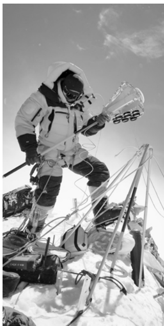
队员将华测北斗高精度接收机P5(左下)带上珠峰峰顶完成测量任务。受访者供图
