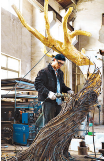
焊接钢筋树干。
