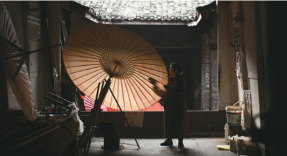
纸的形态和作用在历史上不断变化。图为制伞师在为油纸伞上桐油。
