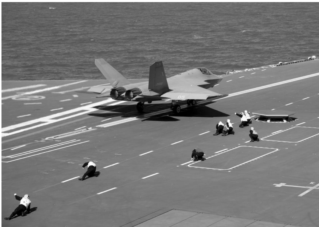
歼-35舰载战斗机从福建舰上电磁弹射起飞。
