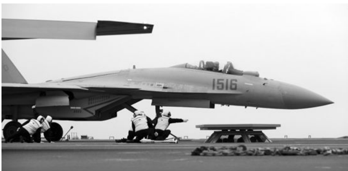
歼-15T舰载战斗机在福建舰上电磁弹射起飞，起飞助理做出放飞手势。
